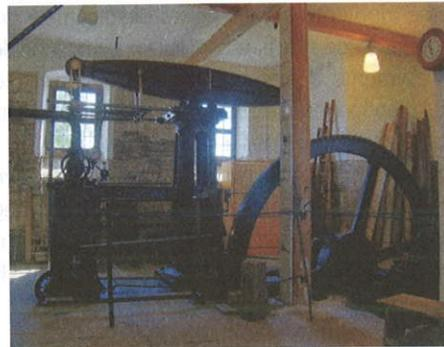
Máquina a vapor de James Watt, construída em 1848, em Freiberg, Alemanha
